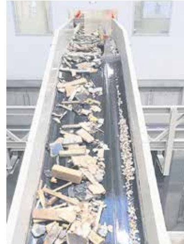
Auf 30 Bändern wird das Material sortiert.
